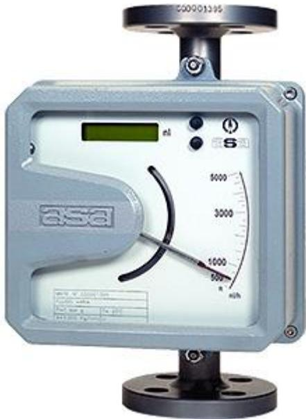
Ротаметры ASA серии С могут быть поставлены в версии с микропроцессором (технология 2-wire) с 8-цифровым LCD дисплеем с указанием текущего, суммарного и процентного расхода, выходной сигнал 4-20мА с протоколом HART (питание 24Vdc±10%) и интерфейсом Profibus PA (по запросу).
